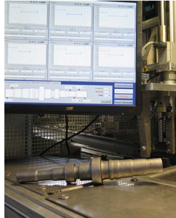
Výkovok – valcový hriadeľ Komentár: Odhaliť vnútornú chybu v tomto valcovom hriadeľi sa okom nedá, dokáže to jedine technológia s ultrazvukom.
